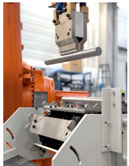
Der Greifer ist eine Entwicklung von LASCO und an unterschiedliche Bauteilgeometrien anpassbar.
