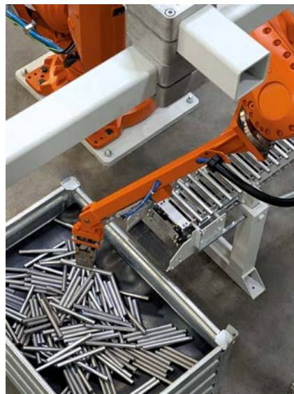
Lage und Orientierung der zugänglichen Teile im Behälter werden automatisch erkannt.
