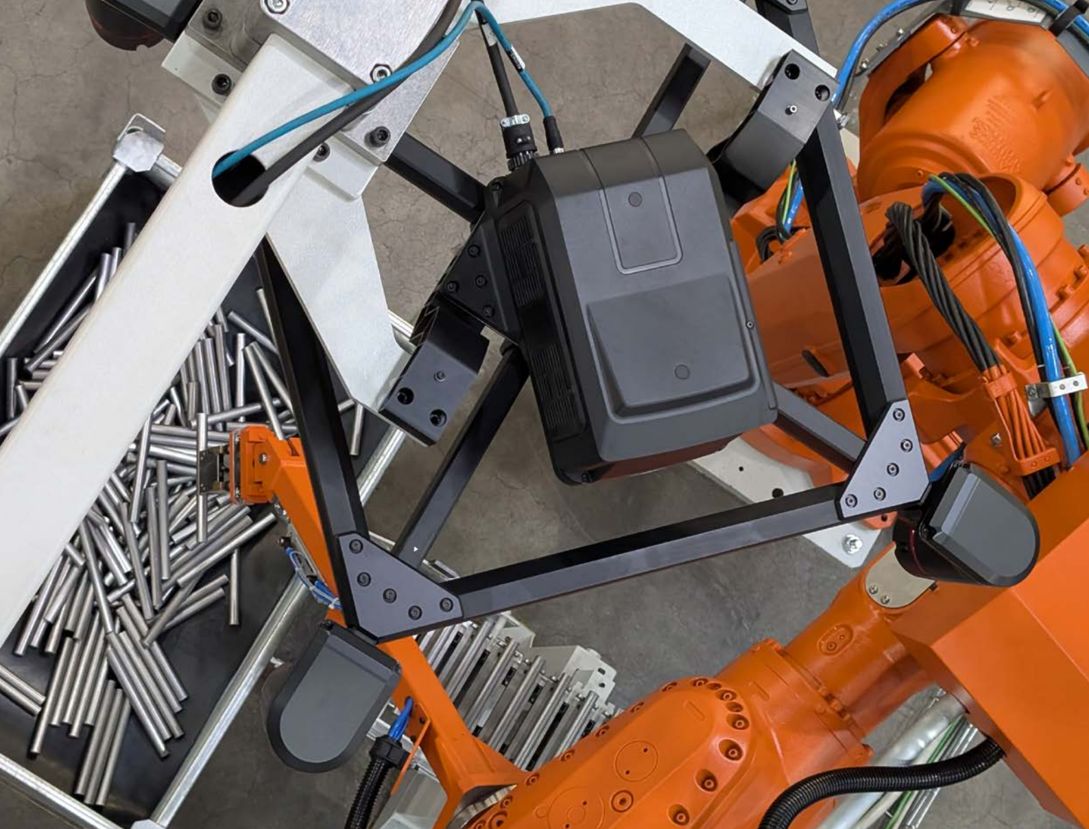
LASCO „NextGen Bin Picking“ ermöglicht eine flexible und materialschonende Handhabung unterschiedlichster Werkstückformen.
