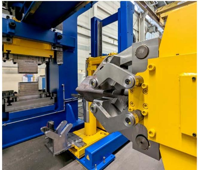
Presse und Manipulatoren werden über eine F-CPU gesteuert.
