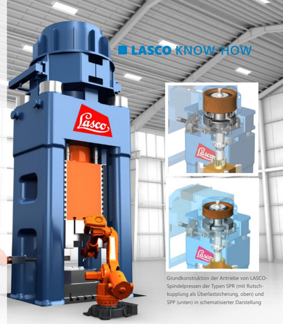
Grundkonstruktion der Antriebe von LASCO-Spindelpressen der Typen SPR (mit Rutschkupplung als Überlastsicherung, oben) und SPP (unten) in schematisierter Darstellung
