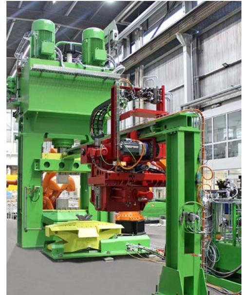
La forge GGF a modernisé la première de ses cinq lignes de forgeage avec la ligne d'étréage automatique LASCO AR 250/250. La photo montre les installations pendant le montage à Cobourg.
