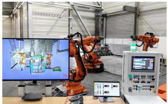
Pendant que la production se poursuit sur la ligne de forgeage réelle, les robots sont programmés en interaction active avec le modèle numérique.
