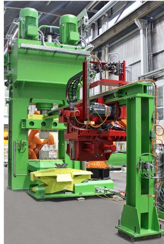
Mit der automatisierten LASCO Reckanlage AR 250/250 hat die Großenhainer Schmiede GGF jetzt die erste ihrer fünf Schmiedelinien modernisiert. Das Bild zeigt die Anlage während der Montage in Coburg.
