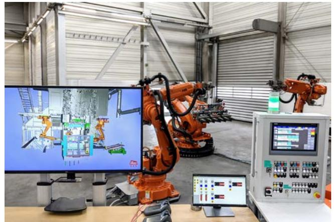
Während auf der realen Schmiedeanlage weiterproduziert wird, werden im aktiven Zusammenspiel mit dem Digitalmodell die Roboter programmiert.
