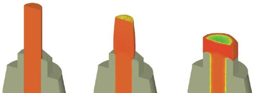
Figure 2: simulation des opérations de préformage conique et de finition
