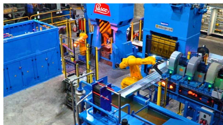
Halbautomatische Schmiedelinie mit LASCO HO-U 500, Stufenförderer, Erwärmungsanlage und Robotern.
