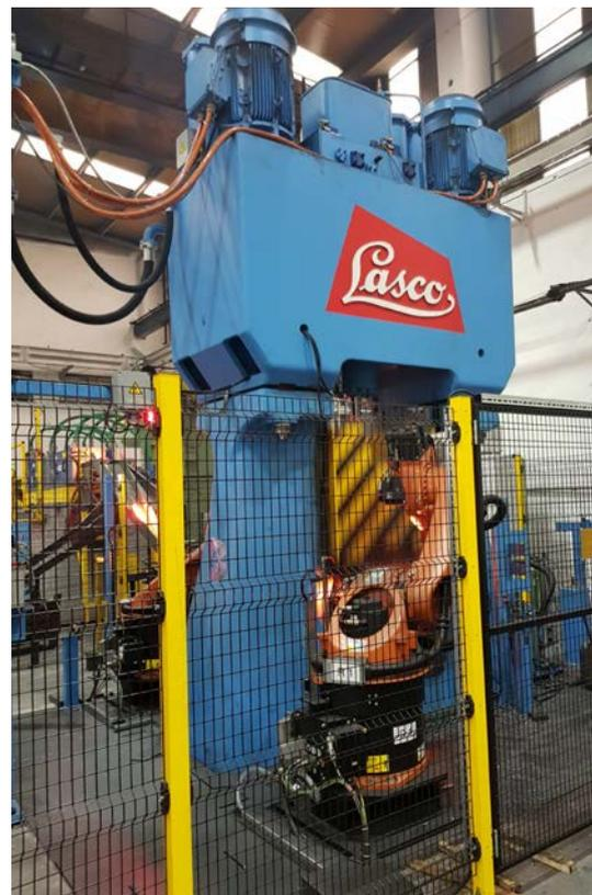
La ligne de forgeage entièrement automatique en service chez MSK Steel Forging.
