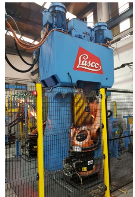
Die vollautomatische Schmiedezelle bei MSK Steel Forging im Einsatz
