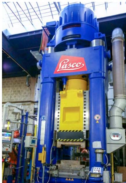
La presse à vis LASCO SPR 2000 pendant les travaux d'assemblage à l'usine HEYCO Sud (Tittling, district de Passau).
