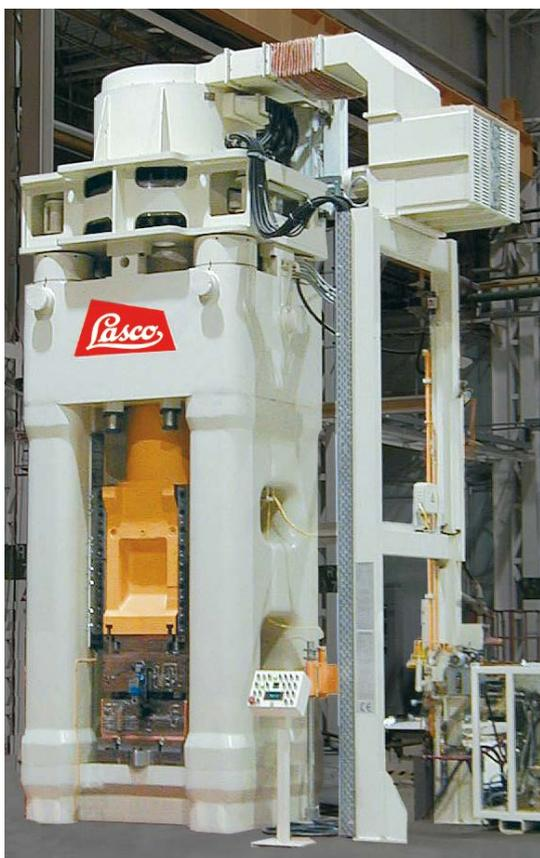
Les presses à vis (Fig. LASCO SPR 2000) peuvent être commandées très précisément grâce au dosage précis de l'énergie de forgeage et sont donc parfaitement adaptées au forgeage de matériaux exigeants comme l'aluminium.
