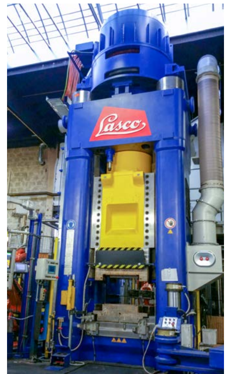
LASCO-Spindelpresse SPR 2000 während der Montagearbeiten im HEYCO-Werk Süd (Tittling, Landkreis Passau).
