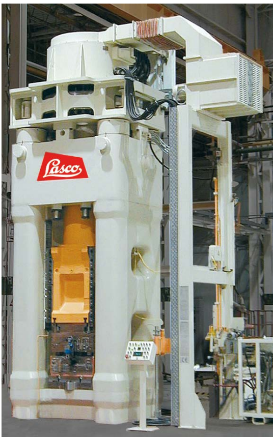
Spindelpressen (Abb.: LASCO SPR 2000) sind aufgrund exakter Dosierbarkeit der Umformenergie sehr präzise regelbar und deshalb für die Umformung anspruchsvoller Werkstoffe wie Aluminium bestens geeignet.
