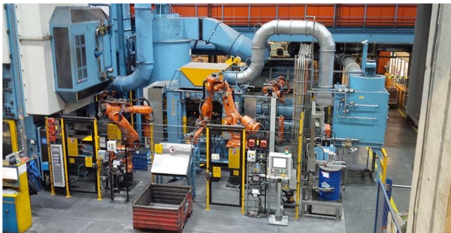
Die Fertigungsline „AMP58“ mit integrierter LASCO-Reckwalze bei der Hirschvogel Aluminium GmbH (HAG) in Marksuhl/Thüringen.
