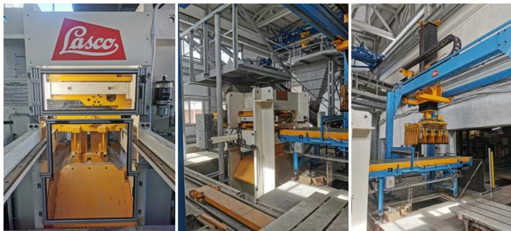
Aufnahmen aus der Produktionshalle der TOO „Silikat“ Semej während der Montage der neuen Kalksandstein-Pressenanlage KSE 401 B von LASCO.
