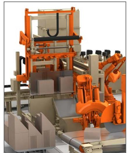
Rohlingsägen sind in die Linie integriert und ermöglichen vollautomatischen Produktionsablauf.
