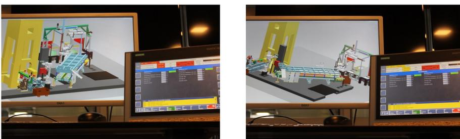
Lange bevor Komponenten produziert werden, ist die Produktionslinie im Computer bereits fertig modelliert (Bildschirme) und mit der Original-Steuerung (Terminal rechts davon) wie in der Realität bedienbar. Der gesamte Produktionsprozess wird im Vorfeld so bis ins Detail und mit allen Parametern durchgespielt und optimiert.
