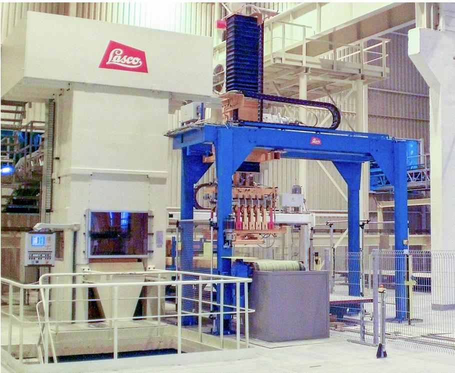
Eine moderne KSP 801 von LASCO ersetzt bei der AB Silikatas Akcine Bendrove in Vilnius eine alte mechanische Presse.
