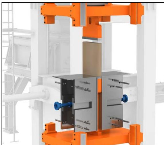
Прессование и сброс формата с толщиной стенки 115 мм
