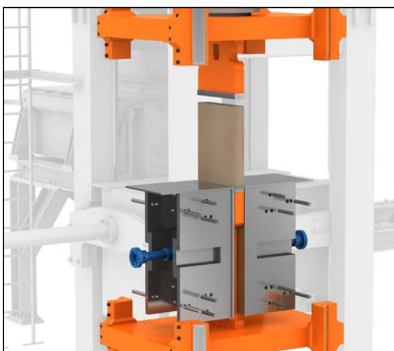
Pressen und Auswerfen des Formats 115 mm Wandstärke
