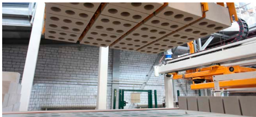
28 силикатных блоков за одну рабочую операцию производит пресс LASCO KSP 801 на «Производственном Объединении Завод силикатного кирпича» (ЗАО ПО ЗСК) в Волгограде.
