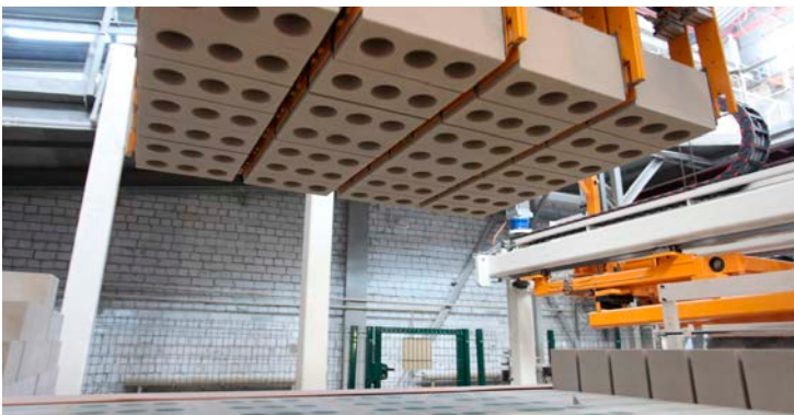
28 Kalksandsteinblöcke in einem Arbeitsschritt verarbeitet die LASCO KSP 801 bei der „Produktionsvereinigung Kalksandsteinwerk“ (ZAO PO ZSK) in Wolgograd.
