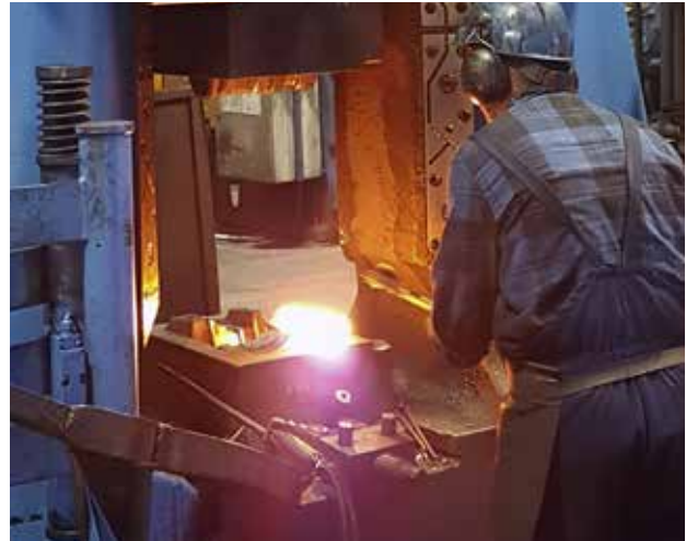
Ковка соединений станины
