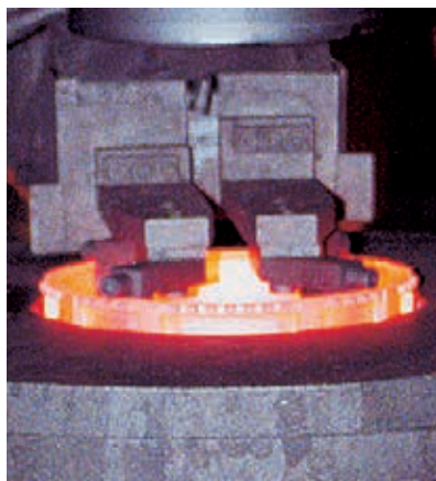
Калибровка в горячем состоянии блокирующих колец синхронизатора
