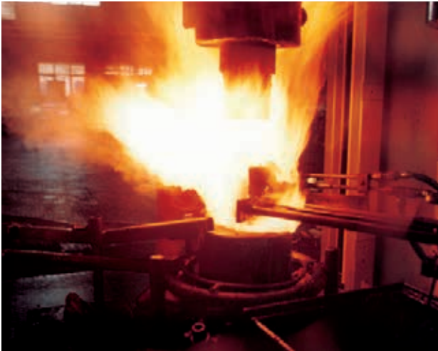
Прессование поршня (продувка штампа)
