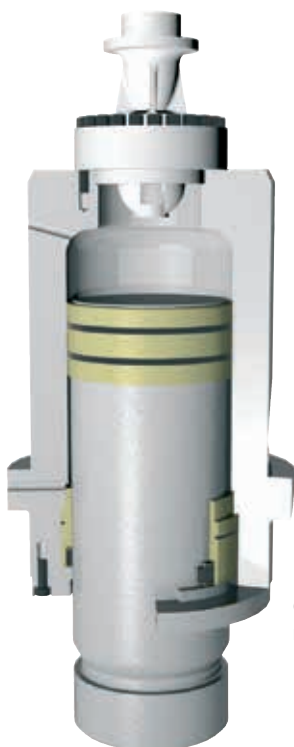
Схематическое изображение рабочего цилиндра пресса LASCO MXP
