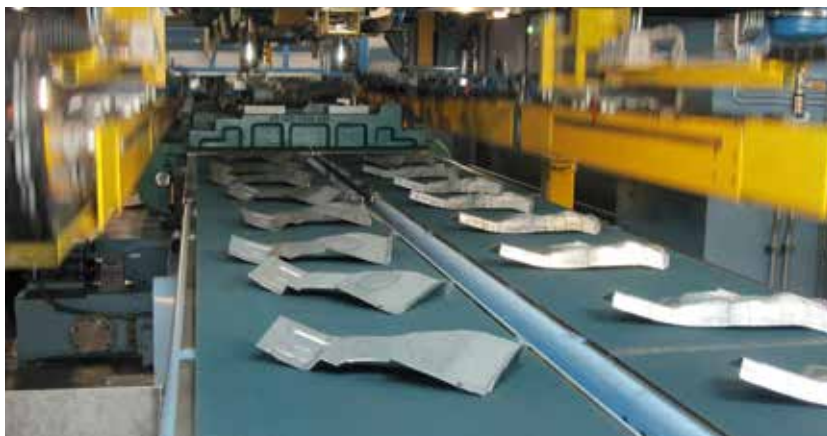
Штампованные детали лёгкой конструкции на ленточном транспортёре
