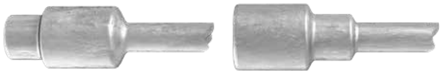
Буртик на торцевой стороне заготовки или на стороне стержня
