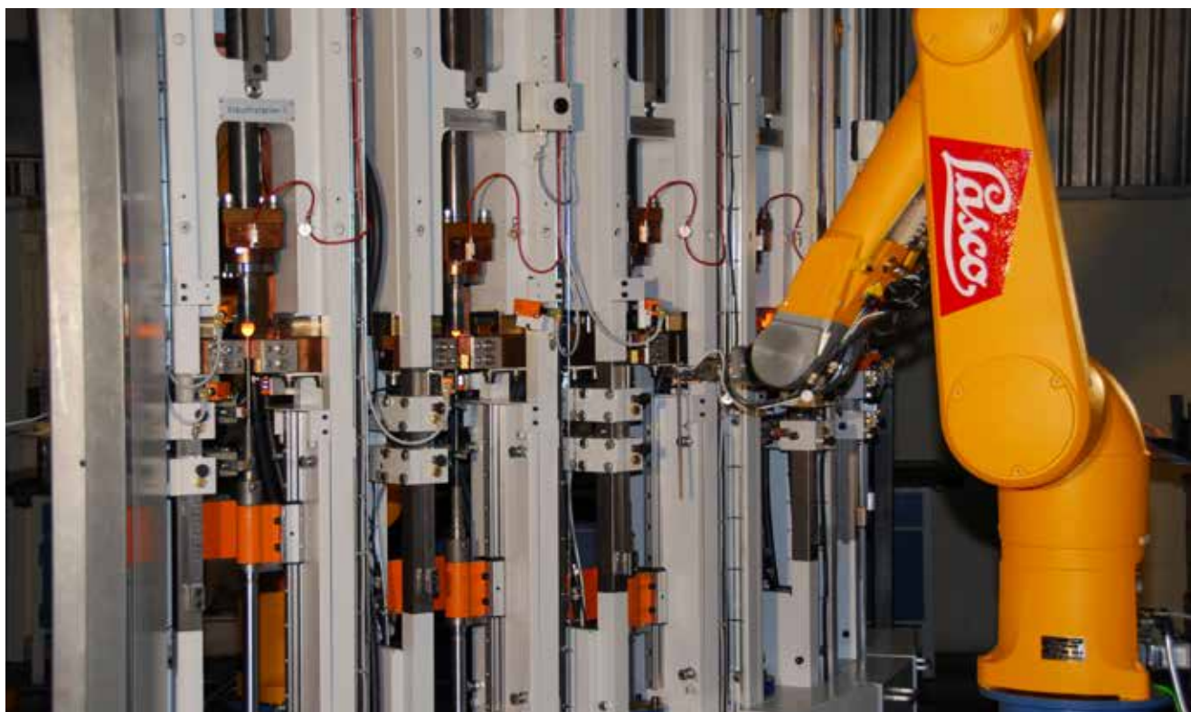
Электровысадочная машина EV 16 с 6ю высадочными узлами
