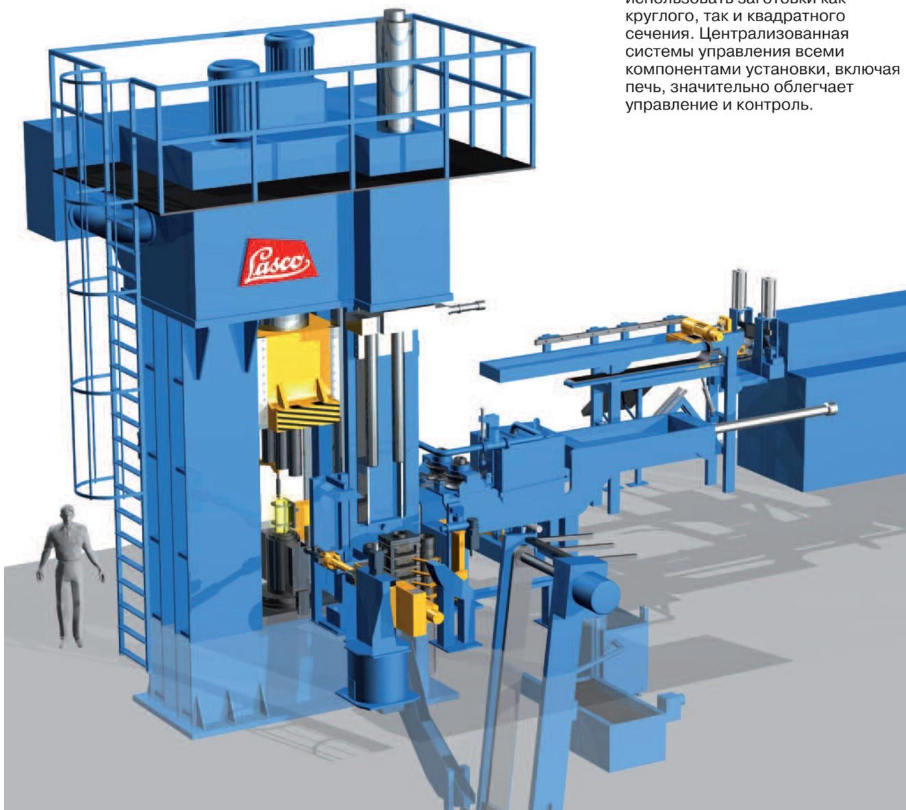
Универсальный дыропробивной и вытяжной пресс VPZ 500 производства LASCO с устройствами автоматизации.
