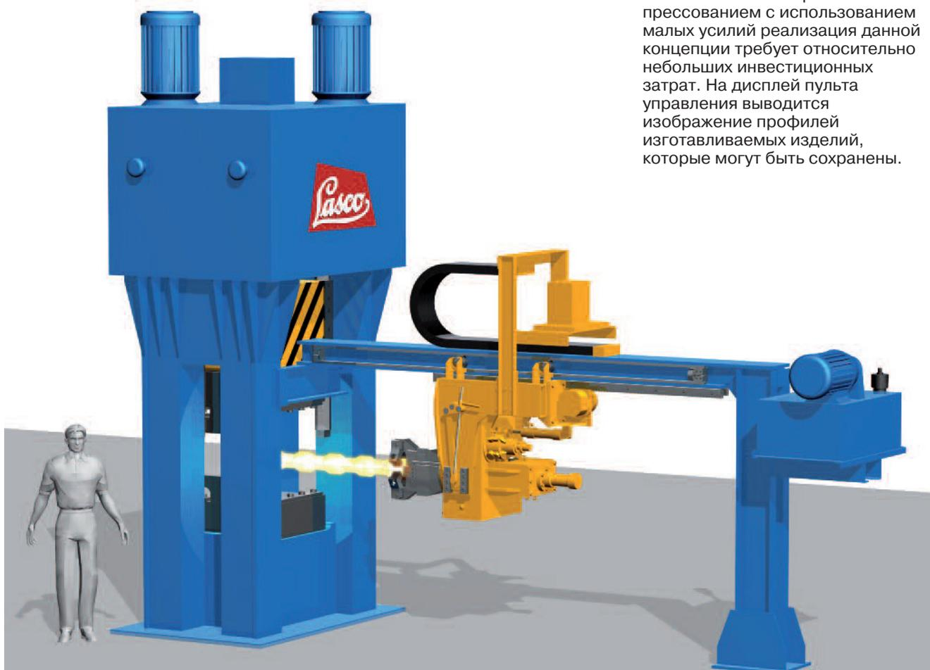
Вытяжная установка AR 250 производства LASCO, состоящая из гидравлического пресса VPE 250 и манипулятора.
