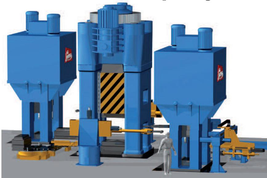
Производственная линия из трех прессов VPE 630, SPR 2500 и VPE 500 фирмы LASCO с устройствами автоматизации.
