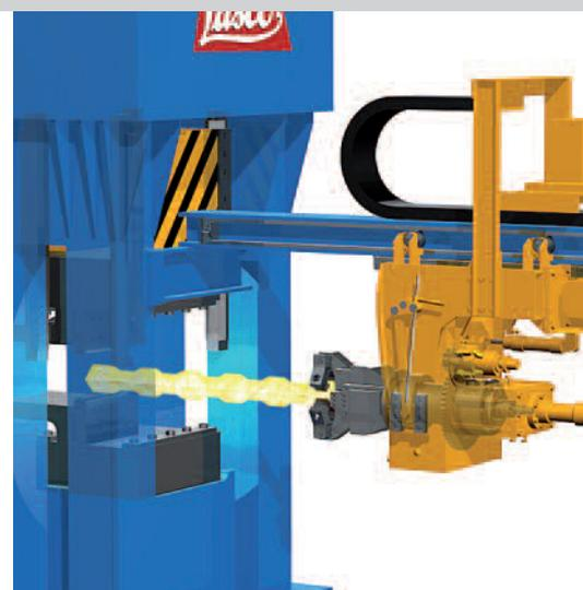
Рабочая зона манипулятора с клещевым захватом, установленном на гидравлическом прессе VPE 250 производства LASCO.
