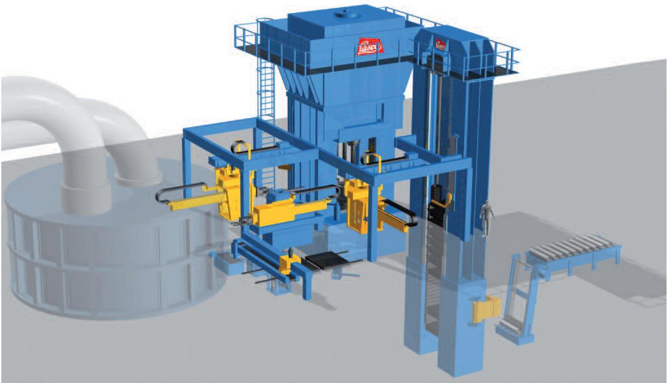
Автоматическая установка с гидравлическими прессами VPA 2500 и VPA 315 производства LASCO.
