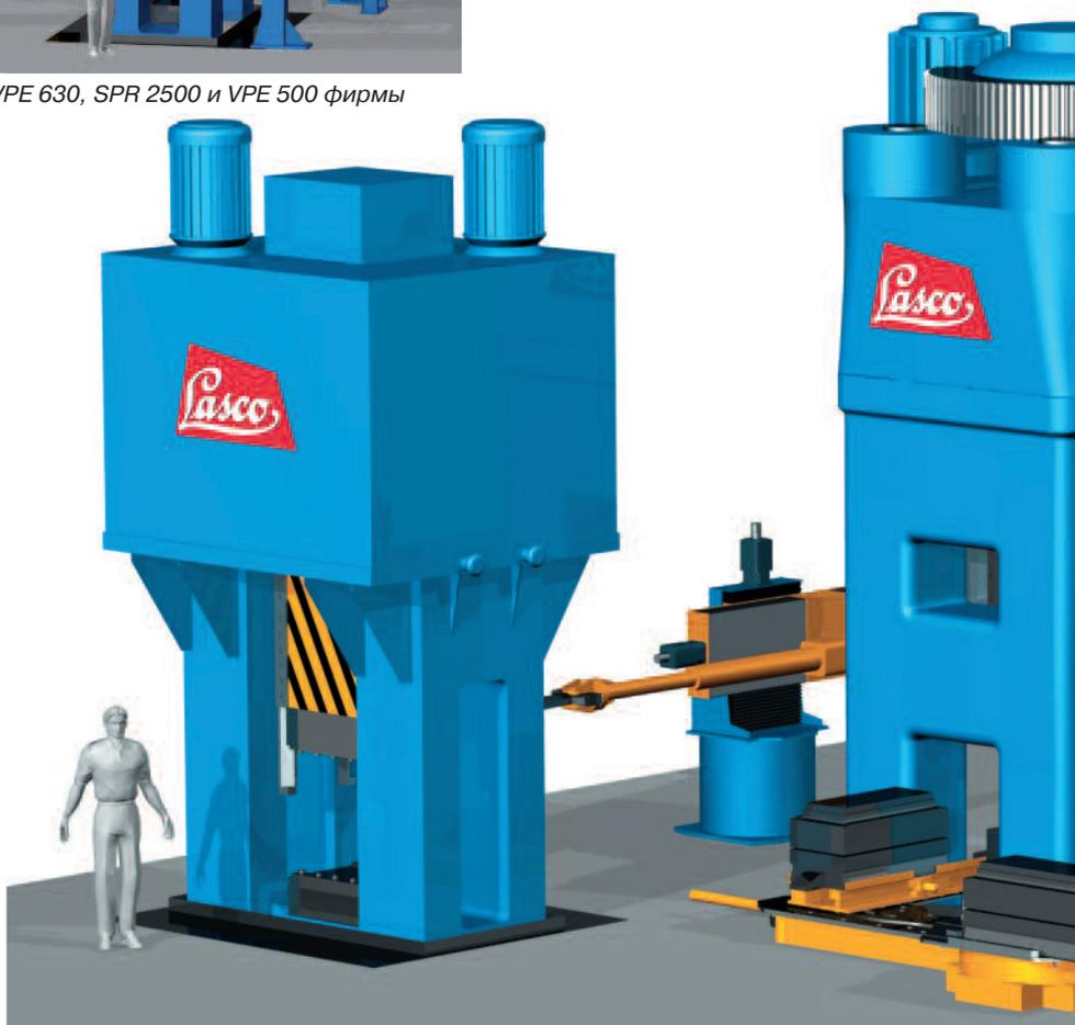
Вид спереди производственной линии из трех прессов VPE 630, SPR 2500 и VPE 500 фирмы LASCO с устройствами автоматизации.
