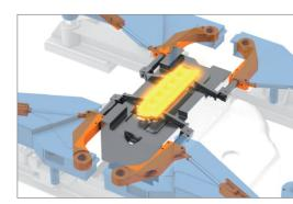
L'éjecteur à coins soulève la pièce forgée et permet au robo de manipulation de prendre la pièce et de la transporter d'u facon sûre.
