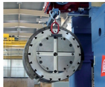
Dispositif de changement de rouleaux : Un changement de rouleaux s'effectue en moins de 10 minutes
