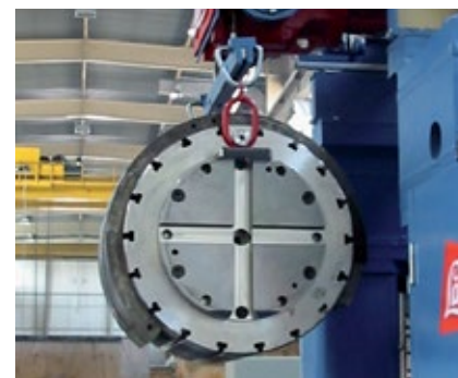
Walzenwechselvorrichtung: In weniger als 10 Minuten ist der Walzenwechsel durchgeführt
