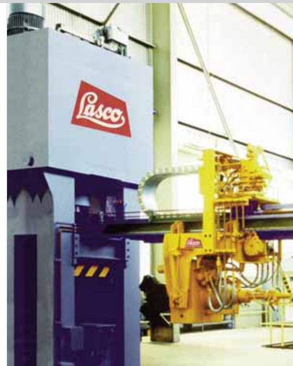
Reckanlage AR 160 zur Herstellung von Vorformen für LKW-Achsen.
