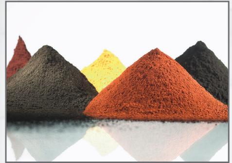
Einen dauerhaften und gleichmäßigen Farbeffekt erzielt man jedoch nur durch die Färbung der gesamten Kalksandsteinrohmasse mit Farbpulver. Ein Anstrich kann die Dauerhaftigkeit der Direktfärbung nicht ersetzen und verdeckt zudem die charakteristische Struktur des Kalksandsteins.
