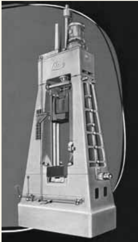
Weltweit erster elektro-öhydraulischer Gesenkschmiedehammer LASCO Patent Nr. 974854 von 1951
