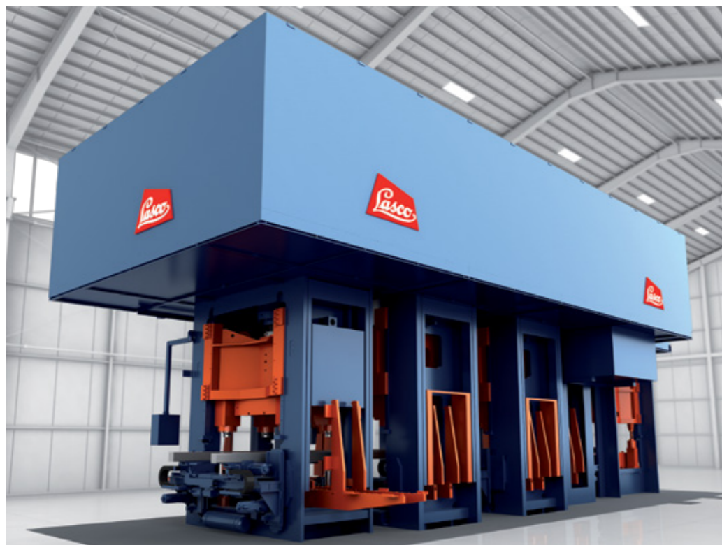
Pressenlinie bestehend aus fünf Tiefziehpressen
