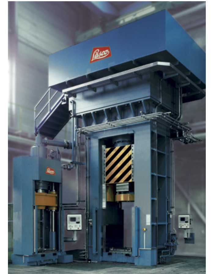
Auf einer VPE 160 und VPE 500 werden Kolben hergestellt.
