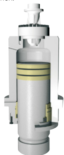
Presszylinder einer LASCO MXP im schematischen Aufriß
